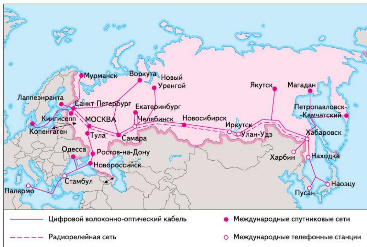
Рис. 62. Трансроссийская система волоконно-оптической связи
